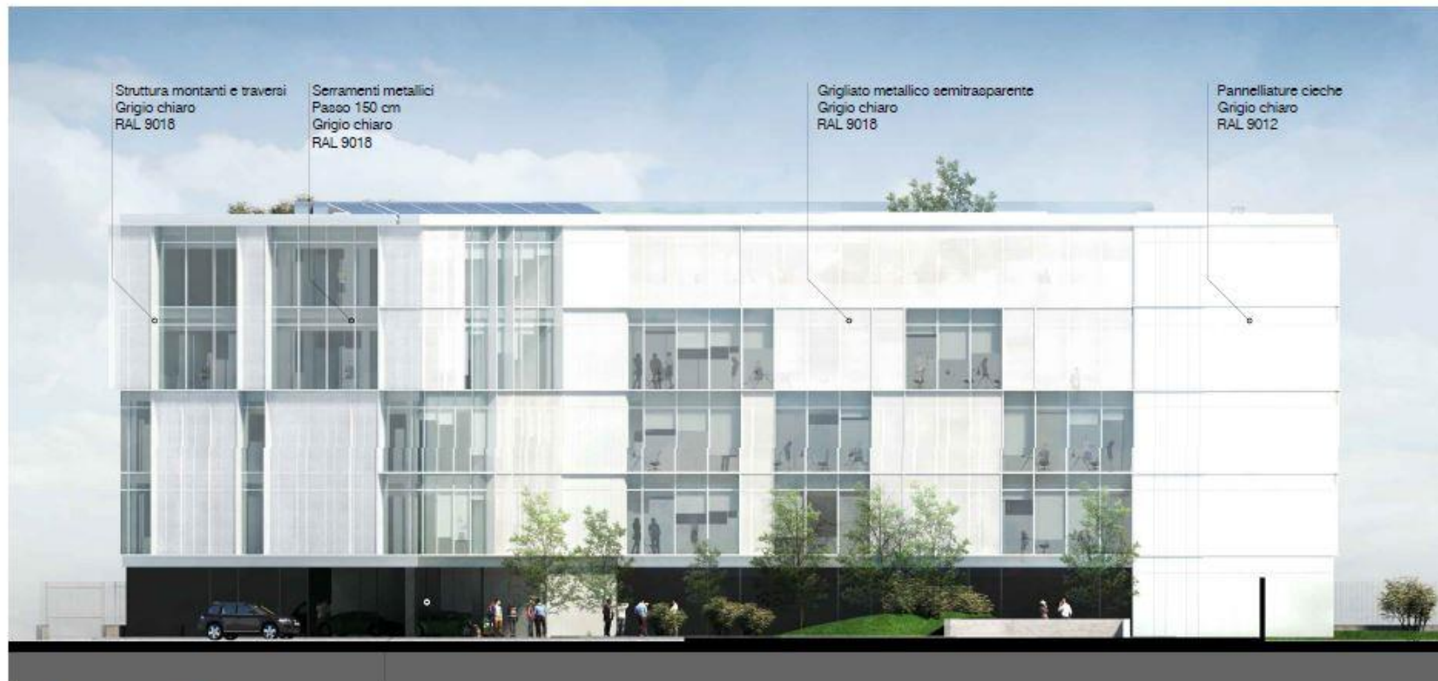
Prospetto C Ovest su cortile/ Progetto
